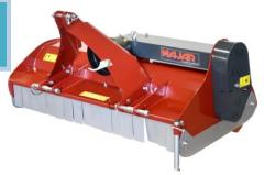
Largeurs de travail 100, 115 et 130 cm. Attelage arrière 3 points cat.1. Livrée avec transmission à cardan. Boitier avec roue libre incorporée. Déport à 3 positions, 0 – 5 - 10 cm.
